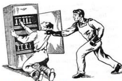
Рис. 4. Освобождение пострадавшего от токоведущей части электрического тока
