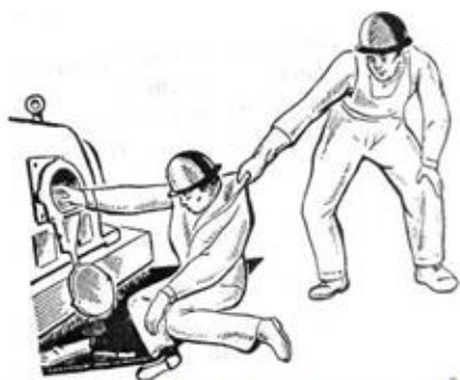
Рис. 3. Освобождение пострадавшего от действия электрического тока путем отключения электроустановки
